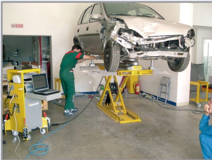
ベンチにアームを取付けて計測作業を行う。
